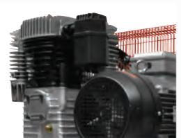
Luftpressor 2-stufig mit 3 Nachkühlern aus Alu-Druckguss, Zylindergehäuse aus Stahlguss
