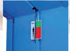
Anzeige für die richtige Sägebandspannung
