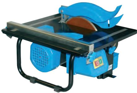
Mobiler und robuster Fliesenschneider. **Ausstattung:** Diamant-Trennscheibe 180 mm, Diagonalschneidlehre, Parallelanschlag mit handlichen Klemmschrauben, eingelegte Skalen im Tisch integriert, durchzugstarker Induktionsmotor und Fehlerstromschutzschalter für optimale Sicherheit. **Einsatzgebiete:** Ideal für Baustellen oder Innenausbau.
