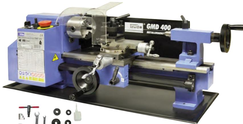
Präzisions Drehmaschine zum **Drehen und Gewindeschneiden** von Baustählen, NE Metallen, Kunststoff und Holz. Mit stufenloser Drehzahlregulierung, Rechts-/Linkslauf und **automatischer Vorschubeinrichtung** zum Gewindeschneiden und der Möglichkeit zum automatischen Längsdrehen. Es können auch noch längere Werkstücke als 300 mm bearbeitet werden, sofern der Durchmesser 15 mm nicht übersteigt. **Drehmeißelaufnahme 8x8 mm.**
