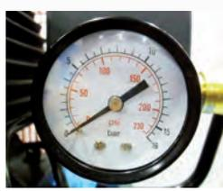
Manometer zur Messung des Betriebsdrucks
