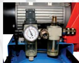
**3 DL-Ausgänge** (Druckluftanschluss am Kessel, geregelter Druck am Druckminderer/Nebelöler)
