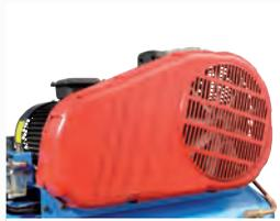
**Große Keilriemenabdeckung** mit optimaler Luftführung und Schutz
