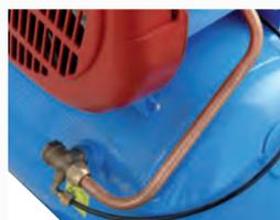
**Rückschlagventil**, Druckleitung aus Kupfer und Entlastungsleitung
