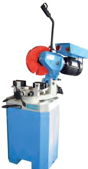
Leistungsstarke Kappsäge, für den professionellen Einsatz geeignet. Massiver Gußsockel mit Auffangwanne für Kühlflüssigkeit, inkl. Sieb. Großer Schraubstock mit Sterngriff, Motor schwenkbar li./re. 45°, Kühlmittelpumpe und Filter, Hauptschalter, Nullspannungsschalter, Not-Aus-Schalter. Inklusive massivem Untergestell. Lieferung ohne Sägeblatt.
