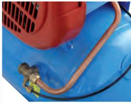
**Rückschlagventil**, Druckleitung aus Kupfer und Entlastungsleitung
