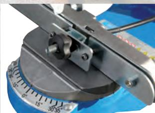
Schnellspannung und Tiltwinkel/Zahndachwinkel
