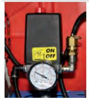
**Condor-Schalter** (Made in Germany) mit integriertem Ein-/Ausrichter und Manometer für Kesseldruck
