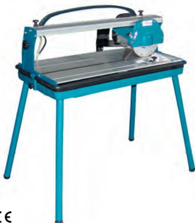
Professioneller Fliesenschneider für Hand- und Heimwerker, komplett mit Kühlwasserpumpe und Wasserwanne, Sägeeinheit 4-fach kugelgelagert, Alu-Anschlag, Führungsschiene, 45°schwenkbar für Gehrungsschnitte. Max. Fliesengröße (diagonal) 360 mm x 360 mm. Max. Schnittlänge ca. 520 mm. **Inkl. Diamantscheibe.** **Mit integriertem PRCD-Schalter** (integrierter Personenschutzschalter für optimalen Schutz).
