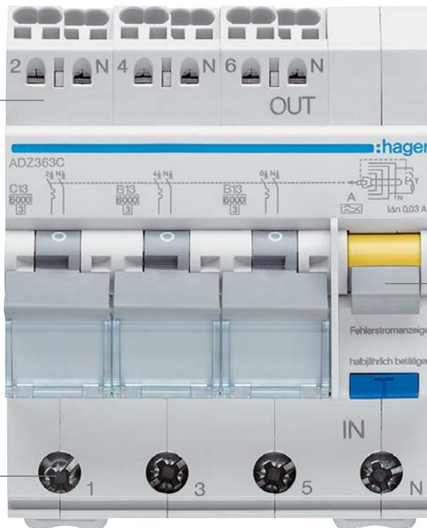
Integrierter 4-poliger (3P+N) Fehlerstromschutzschalter mit gelber Auslöseanzeige. FI-Schutz über die ganze Gruppe (3x 1P+N).
